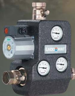
Der Laddomat 21, 22 ersetzt durch seine Konstruktion die klassische Verbindung mit einzelnen Komponenten. Er besteht aus dem gusseisernen Gehäuse, dem Temperaturregler, der Pumpe, der Absperrklappe, den Kugelventilen und Thermometern. Bei der Wassertemperatur von 78 °C öffnet der Temperaturregler die Zuführung vom Speicher. Die Verbindung mit dem Laddomat 21 ist wesentlich einfacher und deshalb von uns empfohlen.
