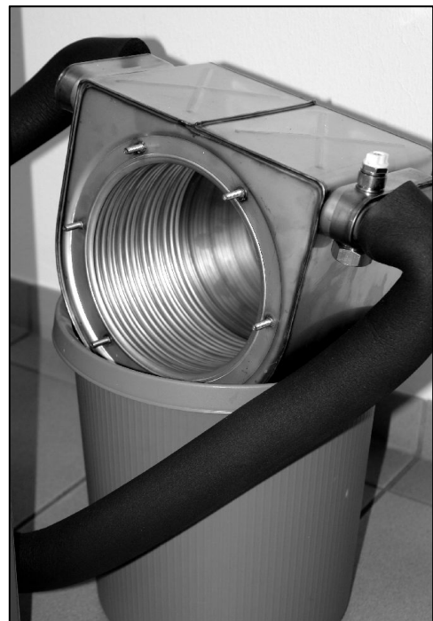
Abb. 125: Wärmetauscher vom Flansch lösen und z.B. auf einem Eimer ablegen. So lässt er sich einfach aussaugen und spülen.
