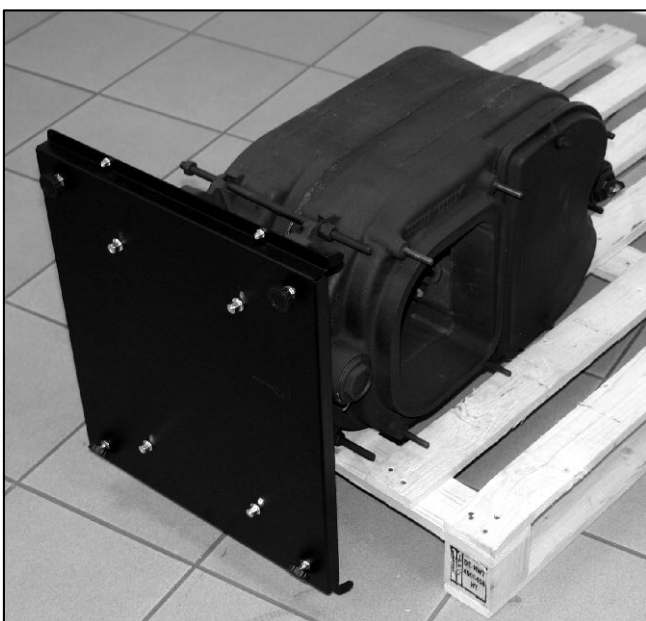
Abb. 17: Die montierte Bodenplatte.
