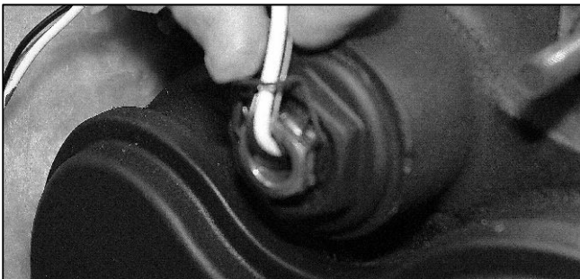
Abb. 69: Kapillarrohre nach oben biegen und Feder wieder aufsetzen.
