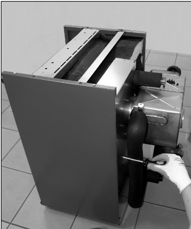
Abb. 62: linke (von der Rückseite gesehen) Rückwandblechhälfte mit Blechschrauben in der Seitenverkleidung und im Bodenblech befestigen.
