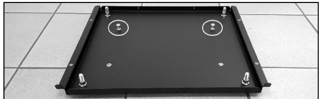
Abb. 13: Bodenblech vorbereiten: 2 Stück Befestigungsschrauben für den Kesselblock (Inbus M8) in die hinteren Gewinde bis auf 10 mm eindrehen.
