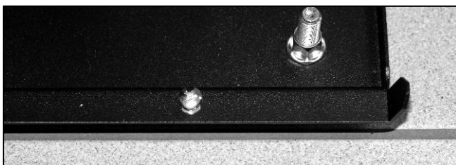
Abb. 52: Kreuzschlitzschrauben M5 in die Gewindehülsen der Bodenplatte bis auf 3 mm eindrehen.
