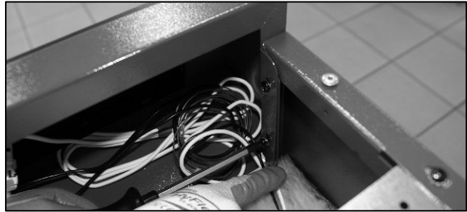
Abb. 71: ... und mit Blechschrauben und Zahnscheiben befestigen.
