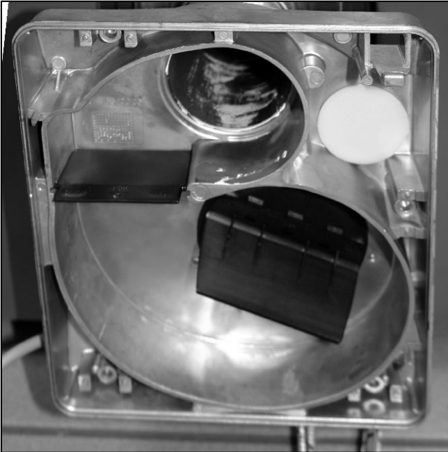
Abb. 88: Den Silikonstopfen nach öffnen des Brennergehäuses in die innere Zuluftöffnung stecken.
