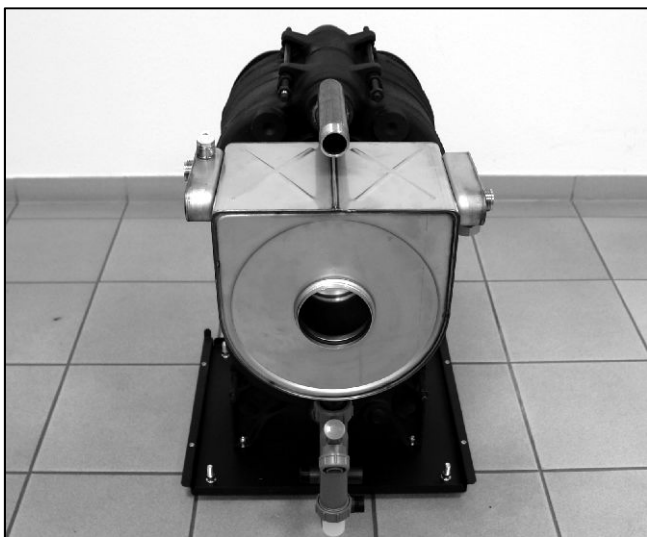
Abb. 39: Abgaswärmetauscher wieder aufsetzen und alle Flanschmuttern gleichmäßig (gegenüberliegend) dicht anziehen. Entlüfterstopfen in den Wärmetauscher einschrauben.
