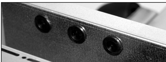
Abb. 51: Kabeltüllen in die hintere Traverse einsetzen
