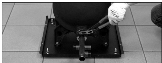
Abb. 25: Rücklaufverteiler einschrauben. Die Gewindemuffe für das KFE-Ventil muss zum Schluss nach rechts zeigen.
