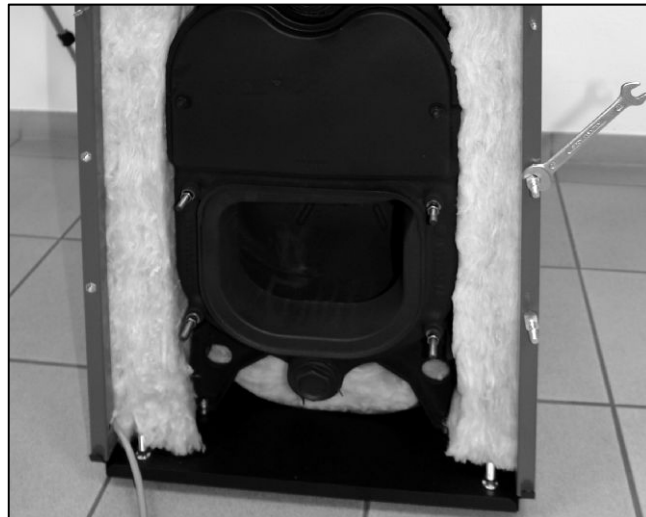
Abb. 64: Tür-Haltebolzen auf der rechten oder linken Seite oben und unten einschrauben.
