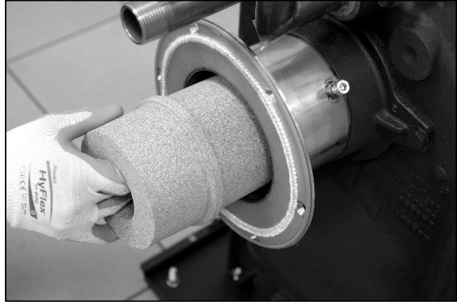
Abb. 36: Schalldämpfer in die auf der Innenseite sichtbare überschüssige, noch pastöse Silikonmasse drücken.
