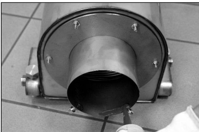
Abb. 28: Vorbereitung: Flansch des Abgaswärmetauschers mit den Klemmschrauben zur flachen Seite zeigend aufsetzen und mit den Edelstahlmuttern handfest anziehen. Mit einer Kartuschenpresse das Hochtemperatursilikon in einer ca. 8mm Raupe umlaufend an der Flanschseite auftragen.
