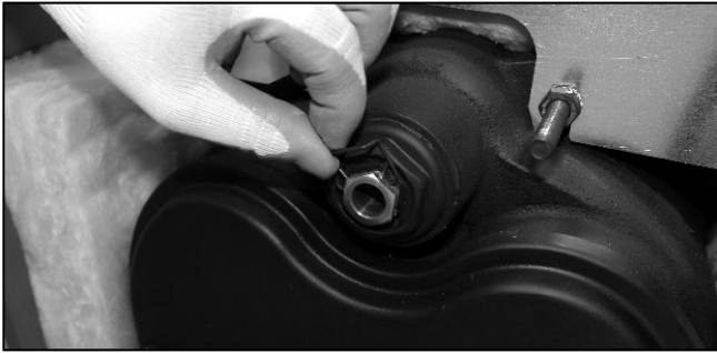
Abb. 67: Sicherungsfeder an der Fühlertauchhülse am Kesselblock abnehmen.
