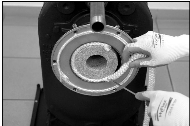
Abb. 37: Zum Fixieren des Dämpfers, die Glasfaserkordel mit einem Schraubendreher in 2 Wicklungen in den Spalt einführen.
