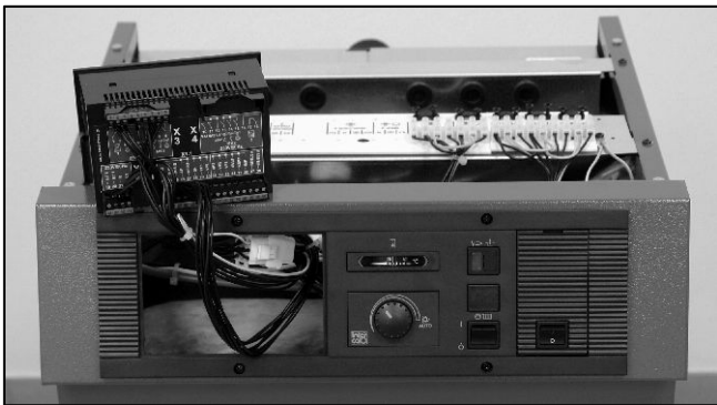
Abb. 118: Reglerkabelsatz in den Steckverbinder stecken, Anschlussklemmen am Regler aufklemmen und Anschlussklemmenwinkel auf der Traverse einclippen.
