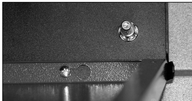
Abb. 53: Seitenverkleidungen auf die Schrauben stecken und bis zum Anschlag der Blechzungen nach vorne schieben. Unter Druck nach außen die Schrauben fest anziehen.
