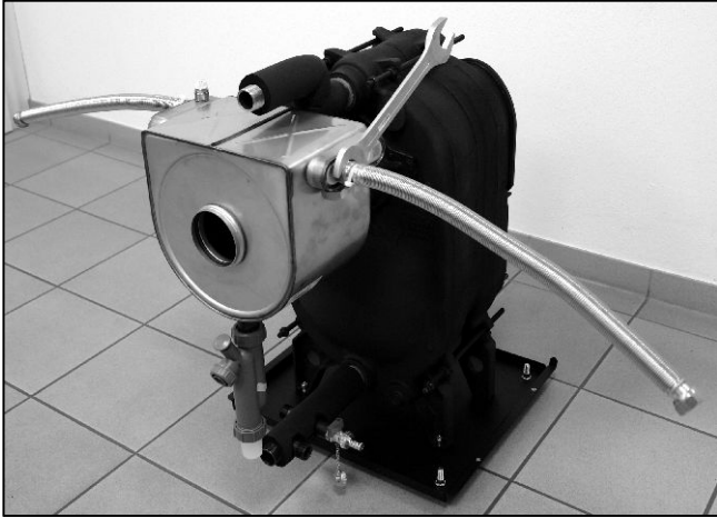
Abb. 44: Die Edelstahl-Wellrohre an die seitlichen Anschlüsse des Abgaswärmetauschers unter Verwendung der \frac{3}{4} "-Dichtungen anschließen.
