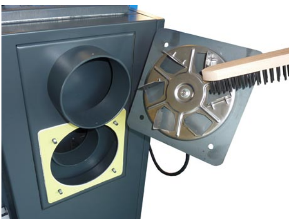
Die Reinigung des Umlaufrades und die Kontrolle des Schaufels bei Saugzugventilator
