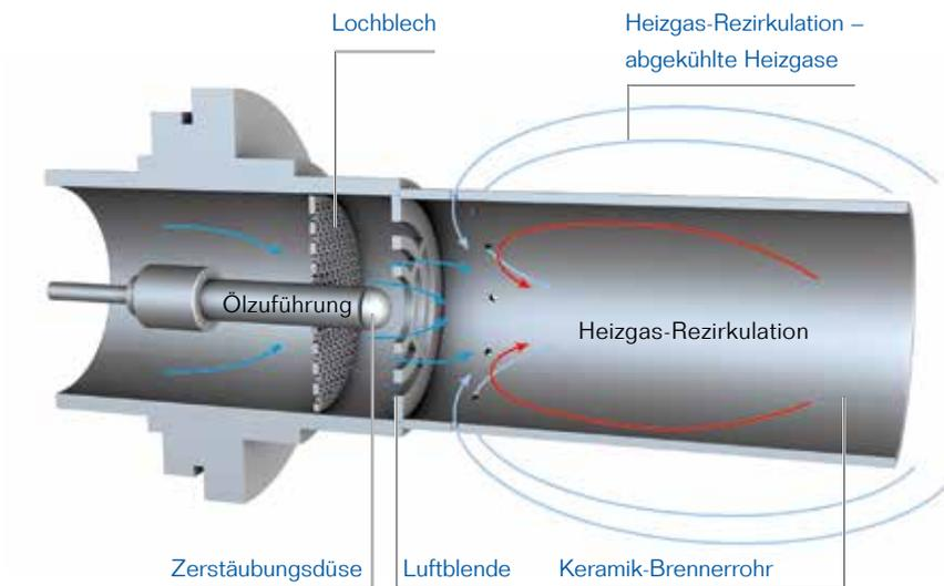
Mit raffinierter Technik garantiert der Blaubrenner Logatop BE<sup>1</sup> eine besonders effiziente und praktisch rußfreie Verbrennung. Ein Unterdruck an der Öl-Austrittsdüse saugt die Heizgase zurück. So verdampfen die Öltröpfchen, bevor sie verbrennen.
