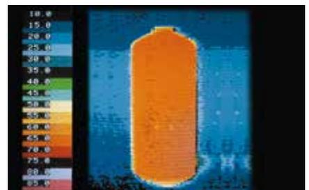
Der Glattrohrwärmetauscher reicht bis zum Speicherboden und erwärmt gleichmäßig den gesamten Speicherinhalt. Das verhindert Kaltzonen und schützt vor Verkeimung.
