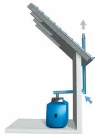
Raumluftunabhängige Aufstellvariante mit Rohr-in-Rohr-Kunststoff-Abgassystem entlang der Außenfassade
