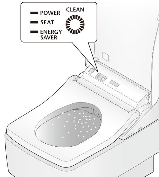
Die Selbstreinigungsfunktionen werden automatisch getätigt.
