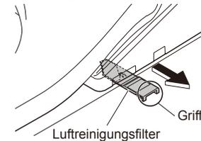
**3** Mit einem Gegenstand wie z. B. einer Zahnbürste reinigen.
